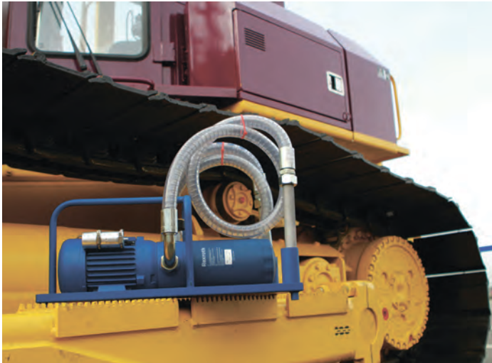
▲ Рис. 4. Очистка мобильных систем (бульдозер)
